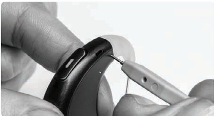
Presione con cuidado la herramienta en el orificio y empujando el pin hacia el otro lado.
