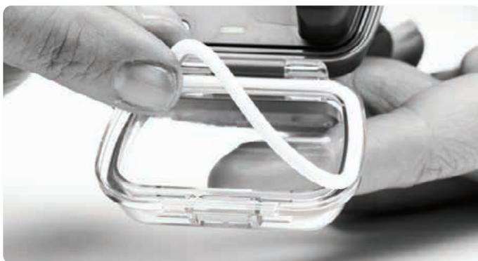
Para introducir la nueva junta tórica, coloque una parte de esta junta en la ranura de montaje de la batería sumergible M ubicada en la caja. Asegúrese de que la forma de la junta tórica se corresponda correctamente con la forma de la batería sumergible M. Mientras sostiene la junta tórica en la ranura con una mano, con la otra estire con precaución el resto de la junta tórica para que encaje en lo que queda de la ranura.
