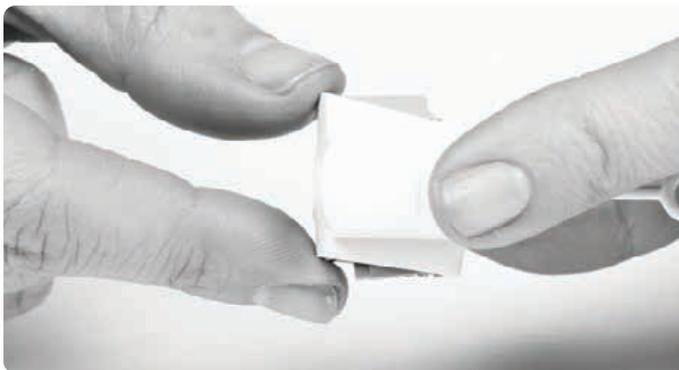
Alinee con cuidado el conector de la batería ubicado en el procesador de sonido con el conector de la batería del accesorio Listening Check M y conecte la parte superior del módulo del Listening Check M con el procesador de sonido.
