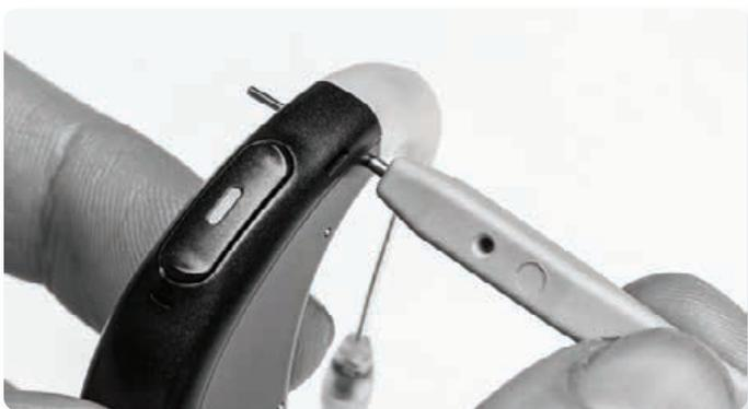
No es necesario extraer el pin del procesador de sonido. Si se empuja la herramienta hasta que quede al ras en un lateral del procesador de sonido, el pin se desplazará lo suficiente para extraer correctamente el gancho auricular. Retire la herramienta del procesador de sonido. Con suavidad, tome el gancho auricular por la parte superior, cerca de donde se conecta al procesador de sonido y tire hacia delante hasta que se separe del procesador de sonido.
