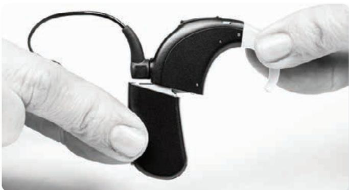
Alinee el conector del paquete de baterías con el lado del conector de la carcasa del procesador.
