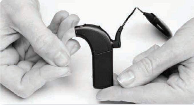
Deslice con firmeza la batería lejos del T-Mic M, el gancho auricular M o el gancho acústico M.
