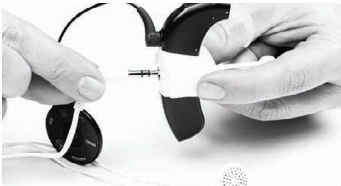
Coloque los auriculares de botón en los oídos del oyente. Cuando se conecta el accesorio Listening Check M, el procesador de sonido ingresa de inmediato al modo de comprobación de la audición. Escuchará la fuente de sonido de entrada del programa de inicio. Si desea escuchar las otras configuraciones de fuente de sonido, use el botón de programa para desplazarse por los programas o inicie la transmisión inalámbrica desde el dispositivo inalámbrico.
