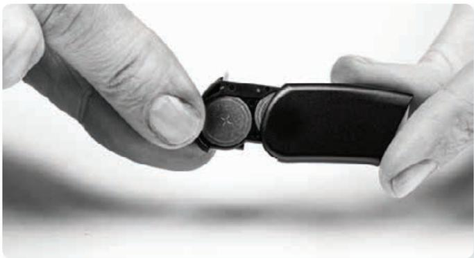
Luego, comience a conectar el paquete de baterías al Naída CI sosteniendo el procesador de sonido con una mano. Rote el cable de RF hacia arriba para evitar golpearlo al colocar la batería.
