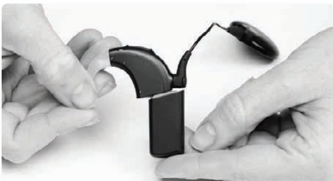
Deslice la batería sobre el procesador de sonido hasta oír un chasquido que indica que ha encajado en su lugar. No fuerce la batería para introducirla en el procesador de sonido. Las baterías están diseñadas para insertarse en una sola dirección; si aplica fuerza, puede dañar el equipo.
