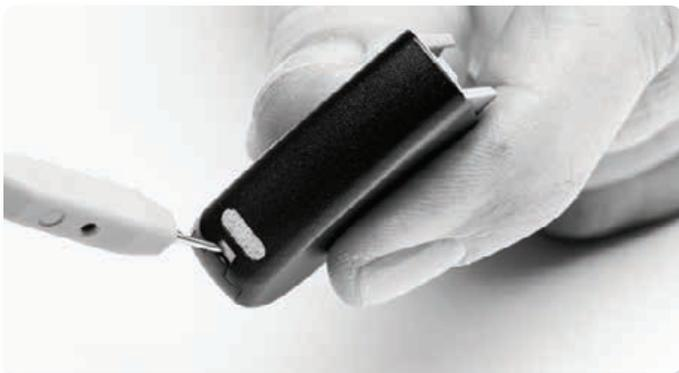
Con la herramienta insertada en el orificio, empuje suavemente hacia adentro y abajo, hasta sentir que el compartimento de baterías de zinc-aire se libera y sale por la parte inferior del paquete de baterías de zinc-aire. Si no dispone de la herramienta, cualquier elemento fino y con punta servirá para liberar el compartimento.
