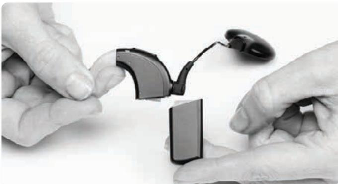
Alinee el conector de la batería con el lado del conector de la carcasa del procesador de sonido.
