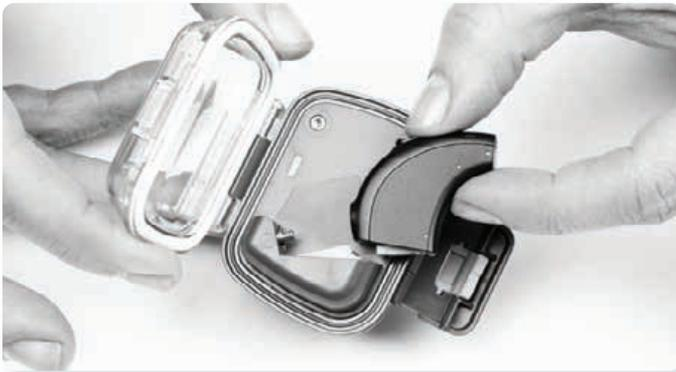
Deslice el procesador de sonido en su lugar hasta que la batería sumergible M y el cable de la antena receptora se acoplen.
