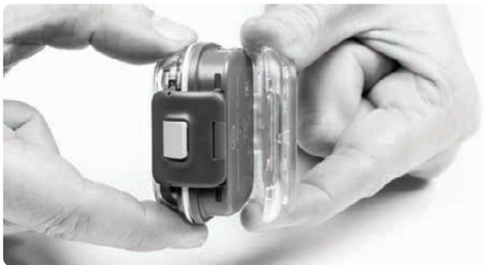
Para extraer el clip, tire el asa del clip hacia atrás alejándola de la batería sumergible M.
