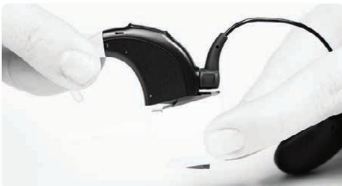
Alinee con cuidado el conector de la batería ubicado en la fuente de alimentación con el conector de la batería del accesorio Listening Check M y conecte la parte inferior del Listening Check M con la fuente de alimentación.
