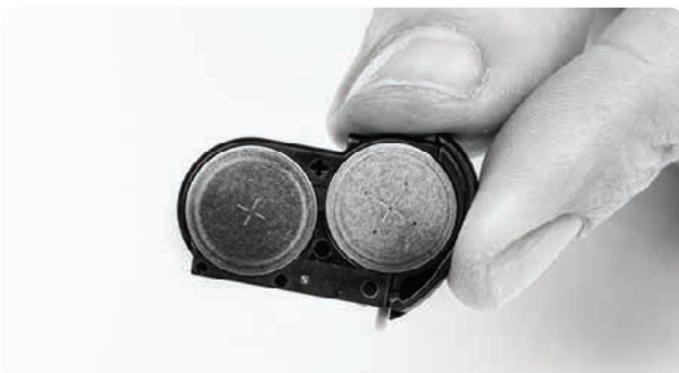
Una vez que las baterías estén alineadas con la parte superior del compartimento, deslice con suavidad el compartimento para baterías nuevamente al interior del paquete de baterías. Si las baterías no se insertan correctamente, el compartimento de la batería no se cerrará.
