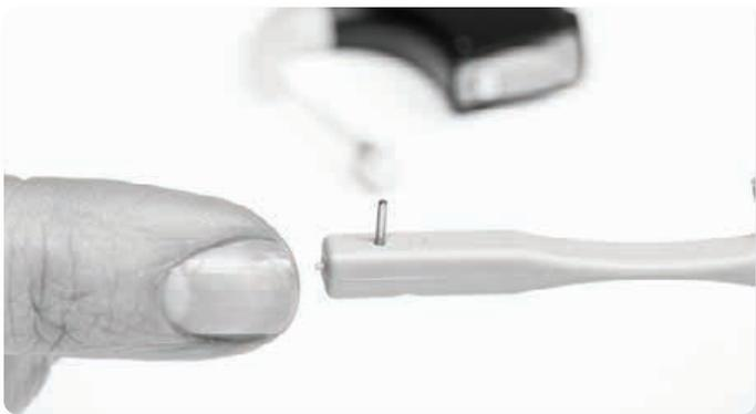
Alinee el pin con el orificio del gancho auricular y empújelo suavemente a través de él. El pin pasará de un lado del procesador, a través del gancho auricular al otro lado del procesador de sonido, sosteniendo el gancho auricular en su lugar. El pin no debe sobresalir del otro lado.
