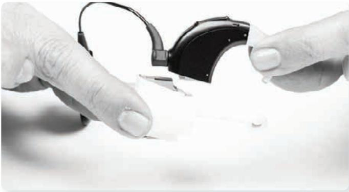
Para cerrar el accesorio Listening Check M cuando no esté en uso, retire los auriculares de botón y, a continuación, sujete las muescas de agarre en el costado del Listening Check M con una mano, mientras sujeta las superficies de contacto del procesador de sonido y la batería con la otra mano. Separe las manos con cuidado hasta que se desconecten las dos piezas.
