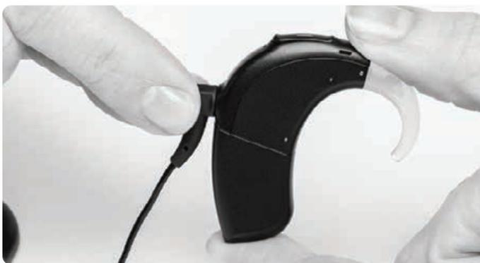
***NOTA: Para maximizar la vida útil del cable, este solo debe desconectarse del procesador de sonido al cambiar la configuración de uso o sustituir el cable.***
