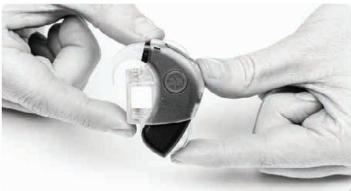
Conecte el cable de la antena receptora al procesador de sonido.
