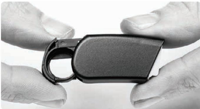
Retire las celdas de la batería de zinc-aire del envase, asegurándose de quitar el adhesivo del lado positivo (+) plano de la celda. Al retirar el adhesivo, se permite el ingreso de aire y la activación de la batería, por lo que debe asegurarse de utilizar la batería inmediatamente después de despegar el adhesivo.
