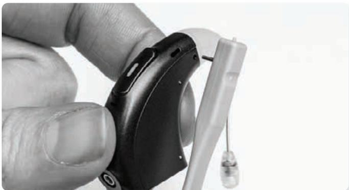
Si una pequeña parte del pin sobresale del procesador de sonido, use el lateral de la herramienta para empujarlo hacia adentro de modo que quede al ras del procesador de sonido.
